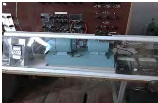
Рис. 9. Готовий стенд для дослідження АД з КЗ-обмотко
