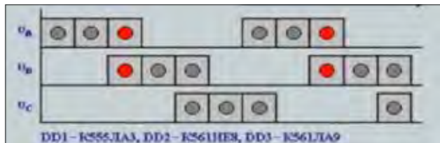
Рис. 3. Прямокутні імпульси, які коригуються обмоткою статора двигуна
