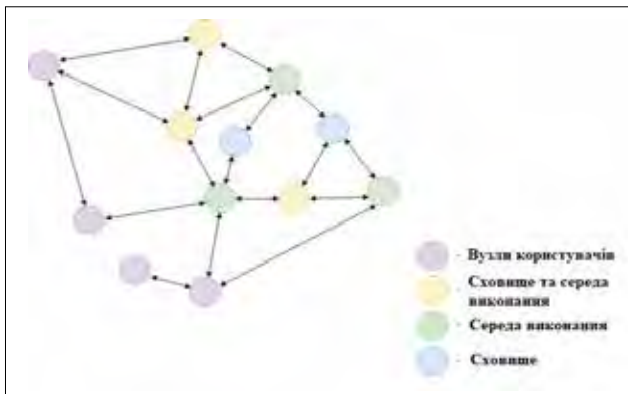
Рис. 1. Модель децентралізованої системи
