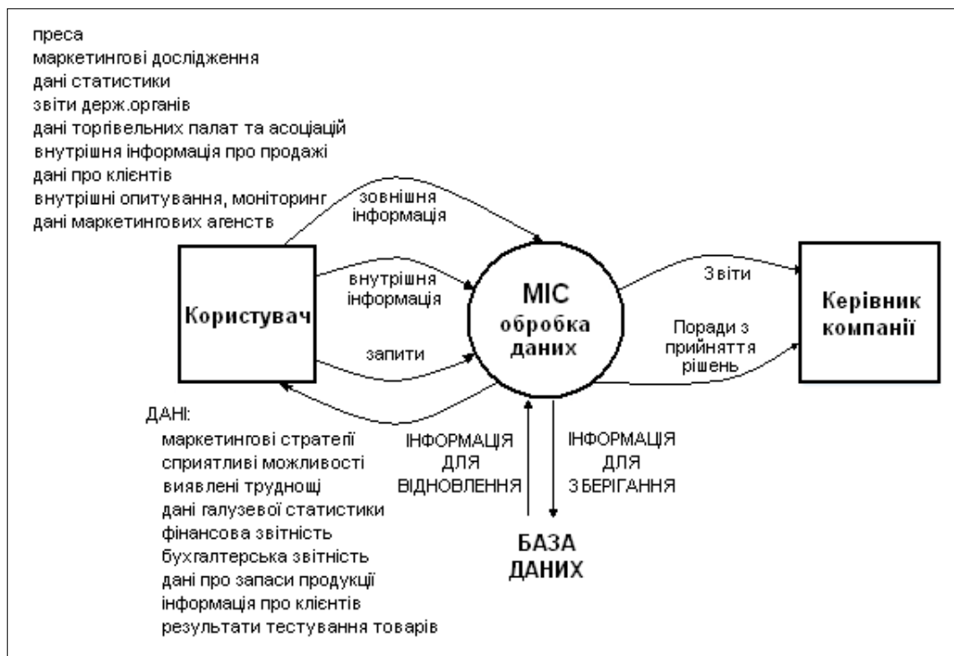
Рис. 3. Діаграма потоків даних системи
